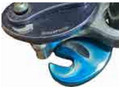
Usure d'un flasque sur Akimbo.
