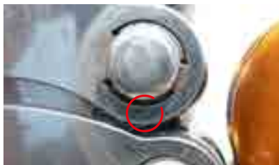
Fissure sur flasque de la chaîne de blocage d'un ZIGZAG.
