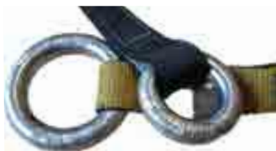
Altération des anneaux d'ancrage.
