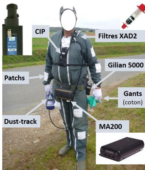
Matériels utilisés dans la mesure de l'exposition
