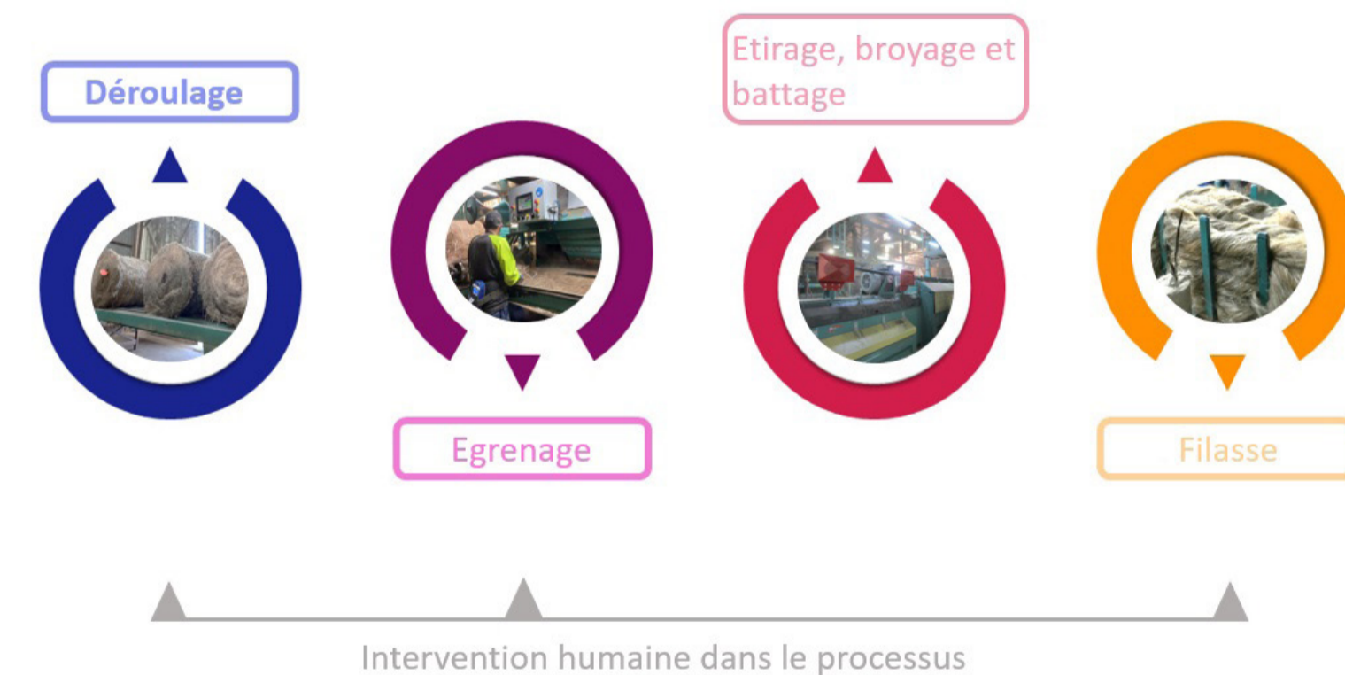
Synthèse du fonctionnement d'une ligne d'un teillage de lin
