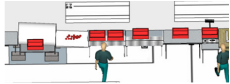
Aménagement facilitant le glissement des caisses (espace tampon, lavabo collectif) et l'optimisation de l'utilisation d'outil existant (laveuse manuelle).
