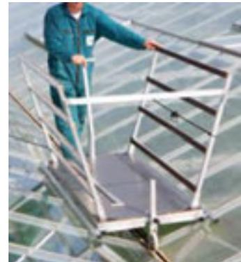
Déambulateur permettant le transport de vitres (a)
