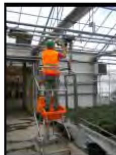
Plate forme élévatrice de personnes (PEMP) de catégorie 1A. Hauteur de plate-forme 2,00m pour une hauteur de travail à 4,00m maximum. Elévation suivant un axe vertical.
