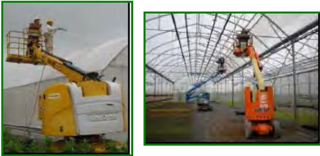
Structurées en différentes catégories, elles peuvent être multidirectionnelles (ci-dessus) ou à élévation (ci-dessous) verticale (pages 69 à 71)
