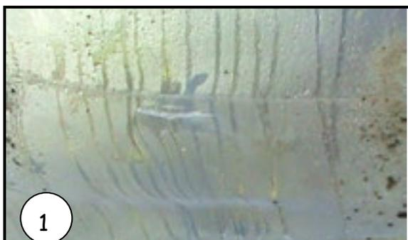
Après 3 tests un constat conduit **INVENIO** à modifier sensiblement le balancier afin qu'il ne présente aucune arrête vive pouvant ainsi déchirer la bâche.
