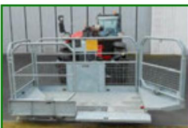
**Pour information :** Un constructeur de matériels automoteurs de levage a mis au point une plate-forme destinée aux couvreurs. Elle est équipée de capteurs autorisant l'ouverture du garde-corps lorsqu'il est en appui sur le toit. **Cet équipement n'est pas adapté aux toitures souples et fragiles des serres plastique ou verre.**
