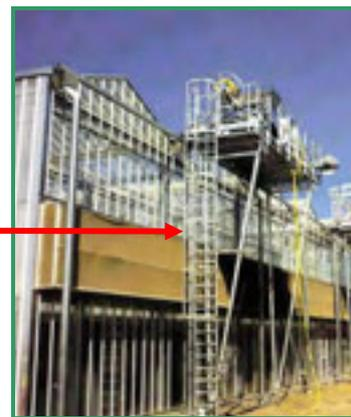
Si cette installation est qualifiée de « **mobile** » pouvant aller de site en site, l'échelle ci-dessus étant mobile l'absence de crinoline conduit le constructeur à préconiser dans la notice d'instructions l'utilisation d'une protection anti-chute avant d'accéder sur la plate-forme.
