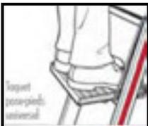
Cette plate-forme horizontale dite « pose pieds » permet des conditions de travail ergonomiques pour effectuer des travaux temporaires en hauteur sur échelle.
