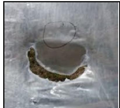
**Test N°5 : Chute verticale** du sac sphéroconique de 50kg d'une hauteur de 1m. T° ambiante et T° du film 24°C. Dans ces conditions (500J), **le film rompt**.
