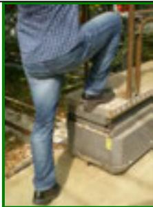
La norme EN 280 (5.6.6), précise que lorsque la plate-forme est à plus de 40cm du sol une « échelle » d'accès doit être installée conformément à l'annexe G. Ainsi l'accès sur la plate-forme du chariot de droite est plus confortable et ergonomique que sur le chariot de gauche ... Code du travail (Art R.4312-1 Annexe I chap. 3.4.5)
