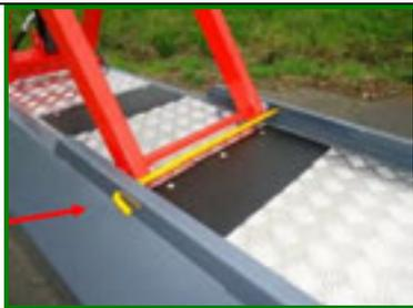
La norme EN 280 (5.4.4), précise que lorsque la plate-forme doit être placée en position élevée pour des opérations de maintenance, un dispositif de blocage installé à demeure doit être prévu pour immobiliser la structure extensible dans la position requise. Le code du travail (Art R.4312-1 Annexe I chap 1.6), indique en résumé (...) que « toute intervention de maintenance doit être effectuée en toute sécurité ».
