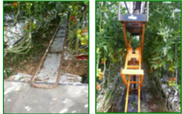
Sur rails (ci-dessus) ou sur pneus (ci-dessous), avec plate-forme de travail élévatrice verticale hydraulique. (pages 72 à 88)
