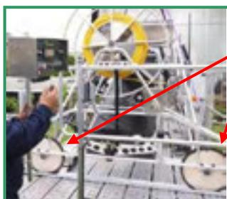
Elle est équipée de 4 roues étroites adaptées à la largeur des chéneaux. Une motorisation électrique (7kw maxi.) permet le déplacement de la machine. En version automatique, plusieurs capteurs contrôlent les mouvements du nettoyeur de toit en bout de chéneaux.
