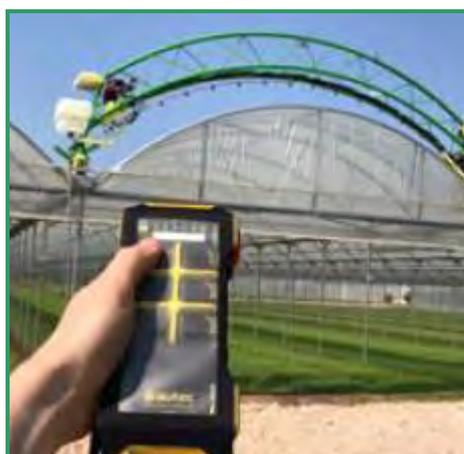
Cette machine, équipée d'un moteur thermique entraîne une centrale hydraulique qui alimente deux moteurs hydrauliques, un sur chaque train d'entraînement.
