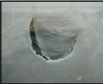
**Test N°4 : Chute pendulaire** du sac de 50kg d'une hauteur de 1m. T° ambiante 34°C et T° du film 40°C. Dans ces conditions (500J), **le film rompt**.
