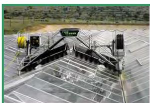
**Machine N°1** : Automatique ou accompagnée - Serres verre - Installée plus généralement à demeure sur les serres ou parfois de manière ponctuelle (Machine VAN DER WAAY page 80).
