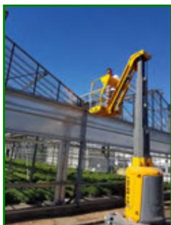
Ces PEMP de **catégorie 3B** sont utilisables pour des travaux tant à l'intérieur qu'à l'extérieur des serres. Leur taille doit être adaptée aux travaux à réaliser comme lavage, blanchiment, bâchage et débâchage, changement de vitres au dessus des serres... De plus et selon leur taille, leur caractéristique multidirectionnelle permet de passer au dessus des cultures et tables de cultures en intérieur.
