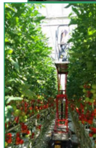
Elévation de la plate-forme de travail par une structure extensible mue par un vérin hydraulique
