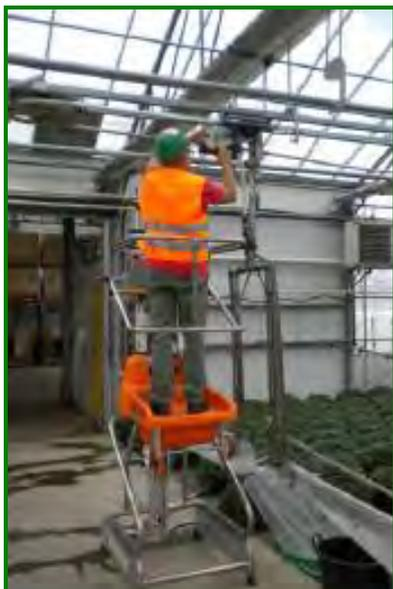
Cette PEMP de **catégorie 1A** présente des caractéristiques intéressantes pour une utilisation dans les serres. Avec une largeur de 740mm elle autorise une portée maximum de 150Kg. Elle se déplace uniquement en position basse comme le précise sa catégorie, à la vitesse de 1m/s maximum. Le plancher s'élève à 1960mm permettant une hauteur de travail entre 3,50/4,00m.
