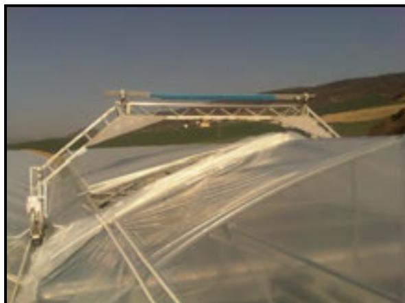
Les utilisateurs debout dans les chéneaux, déplacent simultanément le portique déployant ainsi la bâche sur la structure de la serre.
