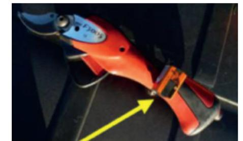
Position du capteur sur la poignée du sécateur.
