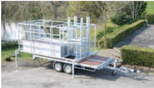
L'utilisation d'une remorque adaptée au transport des éléments d'échafaudage permet de déplacer le matériel aisément entre différents sites.
