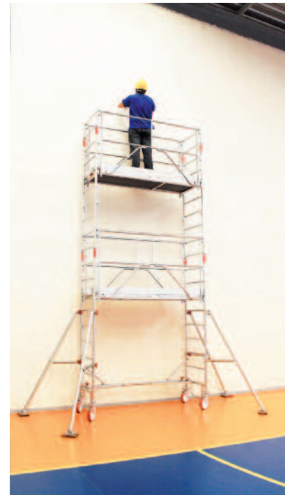
Echafaudage roulant avec stabilisateurs
