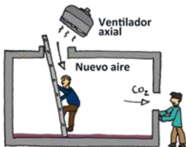
Tanque con dos aberturas.
