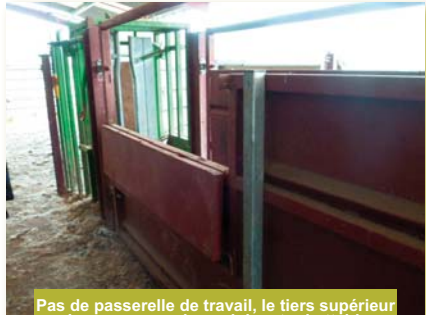
Pas de passerelle de travail, le tiers supérieur des panneaux de couloir est rabattable
