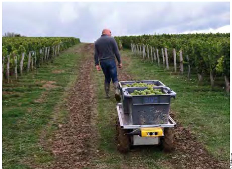
Effibot, le robot-brouette intelligent, peut porter quatre caisses de raisins de 40 kilos dans les vignes.
