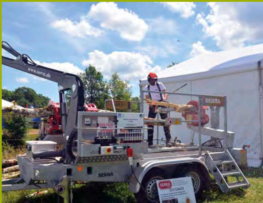
Le simulateur de bridage (ou *Cut Coach*) est un outil pédagogique qui permet de simuler la tension des arbres lors de coupes délicates. Il a été récompensé en 2016 par la MSA pour sa fonction d'outil de formation.
