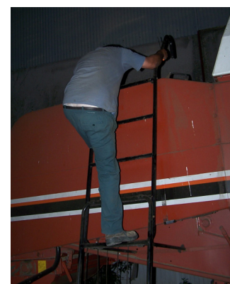
Descente face à l'échelle
