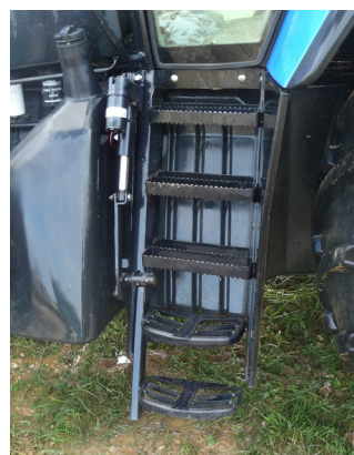
Marche-pied avec ajout d'une marche à commande électrique
