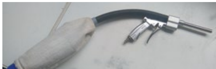
Système d'aspiration à connecter au circuit d'air comprimé (fonctionnement sur le principe venturi).
