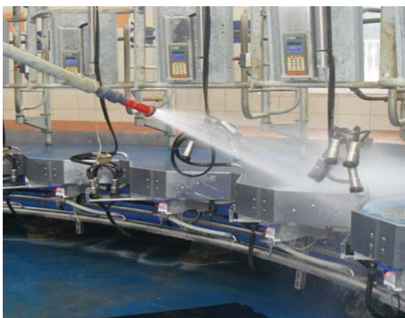
Lavage du manège par rampe fixe.
