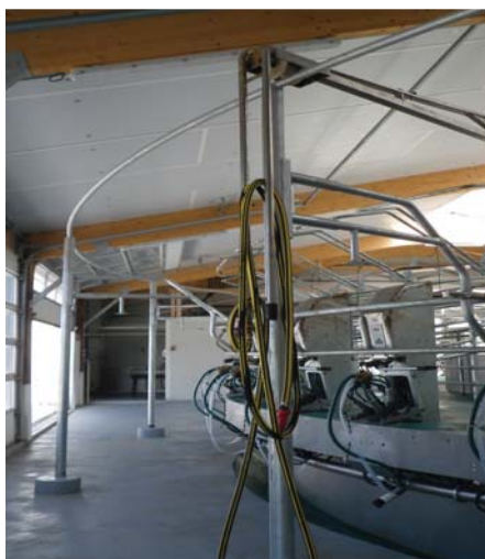
Le tuyau tourne sur un axe fixe grâce à une poulie.
