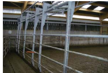
Barrières poussantes dans le parc d'attente
