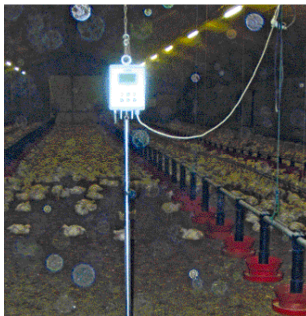
Peson électronique pour pesée automatique - vue entière
