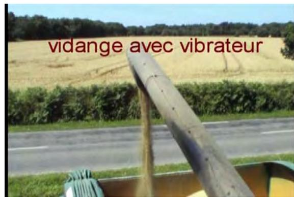
Les contraintes mécaniques redoutées sur la structure de la moissonneuse ne se sont pas avérées. Il faut préciser que sur une saison, la durée de mise en marche du vibreur reste faible comparée au temps d'utilisation de la machine. A titre d'exemple, 70 ha correspondent à 140 vidanges de 3 à 4 minutes soit entre 9 et 10 h sur la saison.
