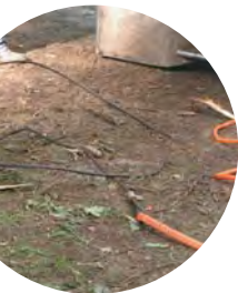
Elingue métallique associé au câble synthétique : préserve des frottements sur le câble synthétique
