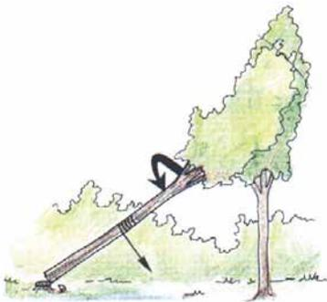
Pour désencrouer un arbre de petite taille, entourer le câble autour du tronc. Lors de la traction, l'arbre tournera sur lui-même et se dégagera.
