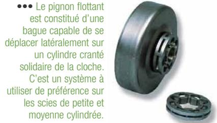
●●● Le pignon flottant est constitué d'une bague capable de se déplacer latéralement sur un cylindre cranté solidaire de la cloche. C'est un système à utiliser de préférence sur les scies de petite et moyenne cylindrée.
