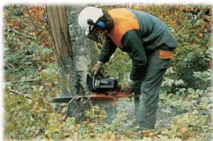
Le pantalon de sécurité protège les jambes en bloquant la chaîne de la scie en cas de contact accidentel.
