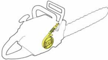
Les scies à chaîne sont équipées d'un embrayage centrifuge mettant la chaîne en mouvement dès que le moteur est accéléré.
