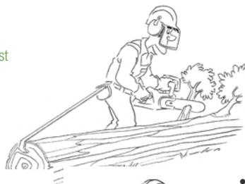
••• Le mètre ruban se déroule pendant l'ébranchage de la partie supérieure du tronc.
