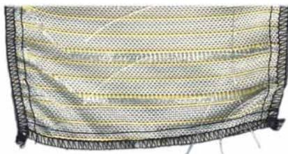
Ces fibres sont tissées spécialement pour pouvoir être tirées par les maillons-gouges de la chaîne sans se rompre. Elles s'enroulent alors autour du pignon d'entraînement et bloquent la chaîne. Cette protection est très efficace.
