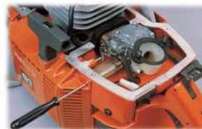
••• Carburateur (vu filtre à air démonté) et accès aux vis de réglage.
