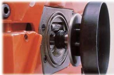
●●● Différents systèmes associent la rotation de la pompe à huile à la rotation de la cloche d'embrayage : aiguille (photo du haut) ; engrenage (photo du bas). Le débit, proportionnel à la vitesse de la chaîne, assure une meilleure économie de l'huile et s'arrête avec la chaîne. Il existe des huiles biodégradables, mais attention à ne pas les mélanger avec des huiles chaîne normales car cela crée une pâte qui obstrue le réservoir et la pompe de la scie à chaîne.
