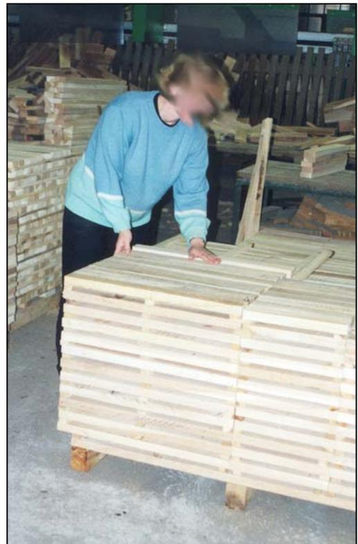
**Photo 6 : Disposition des planches sur une palette quasiment finie →**
