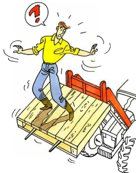
Il est très dangereux d'utiliser le godet ou une palette sur la fourche du chargeur du tracteur pour travailler en hauteur. L'opérateur est à la merci d'un déséquilibre, d'une fausse manœuvre ou simplement de la glissade de la palette ou d'un abaissement imprévu du chargeur. L'élévation de personnel avec des moyens de levage de marchandise est réglementée.
