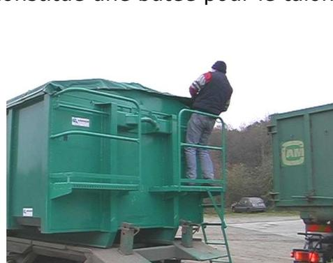
Le garde-corps du côté opposé à l'échelle d'accès aux passerelles présente un retour fixe interdisant la descente par ce côté.
