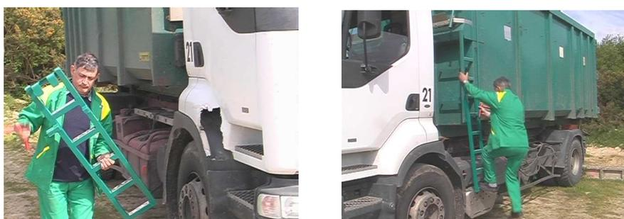
Sur l'arrière du caisson (annexe n°3), 4 barreaux séparés de 43 cm les uns des autres ont été soudés sur la partie intérieure d'une des deux portes. La profondeur de ceux-ci a été portée à 15 cm (+ 6 cm). Une poignée a été ajoutée au sommet de la porte. De ce fait, le chauffeur bénéficie de meilleurs points d'appui et d'une prise haute.
