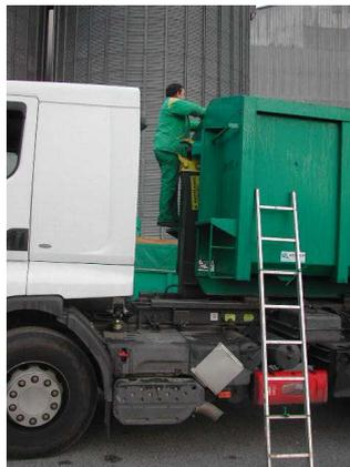
Certains chauffeurs n'utilisent pas l'échelle. Ils montent entre l'avant du caisson et l'arrière de la cabine en prenant appui sur le réservoir pour atteindre les barreaux soudés desservant la plate-forme d'intervention.
