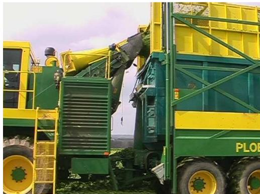
Le savoir-faire du « récolteur » s'exprime lors de la manœuvre de préhension du caisson. En effet, le chauffeur ne bénéficie d'aucune visibilité depuis le poste de conduite. Il guide le crochet de la machine près de l'anneau d'accrochage de la benne grâce à deux caméras fixées à l'arrière et reliées à un écran de visualisation dans la cabine.
