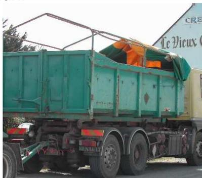
Pour replier la bâche vers l'avant du caisson afin de permettre la prise d'un échantillon par exemple, le chauffeur montait en prenant appui sur la roue arrière puis sur les charnières de la porte arrière.
