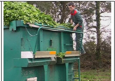
3. Une fois sur le bord de la passerelle, il déplie la lisse supérieure du garde-corps
