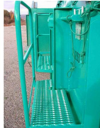
L'espace ouvert entre les passerelles correspond à la place prise par la potence du bras de levage quand le caisson est hissé sur le châssis du camion. Il est réduit au maximum pour faciliter le franchissement par le chauffeur. La forme « entonnoir » est faite pour diminuer le risque de contact de la potence hydraulique avec les passerelles.
