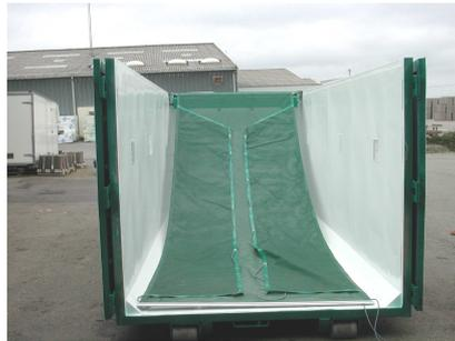
Pour réduire l'effort d'enroulement du filet avec la manivelle et suite à une proposition d'un chauffeur d'une autre coopérative, le fabricant a installé à l'avant de l'axe d'enroulement un 2<sup>ème</sup> rouleau libre. Le filet glisse sur celui-ci ce qui permet de démultiplier l'effort. Même quand des faux plis se forment, l'utilisateur n'a plus à forcer sur la manivelle.
