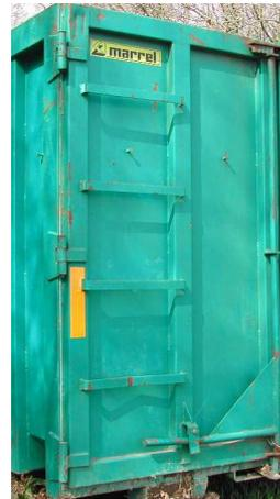
Sur ces faces, la distance entre le point d'appui du pied sur le barreau et la paroi verticale du caisson n'est que de quelques centimètres (par exemple, sur la porte arrière de caisson de légumes, cet espace est de 6 cm sur un modèle de marque Dalby et de 9 cm sur un modèle de marque Marrel).
