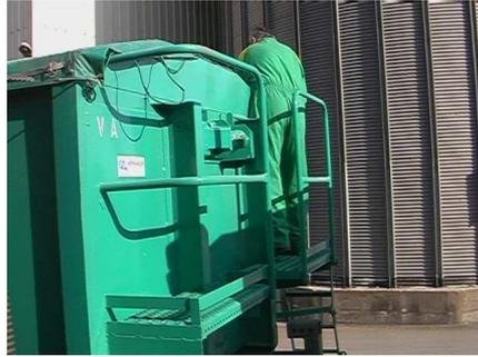
L'écart entre les deux montants verticaux intérieurs des passerelles est de 60 cm.
