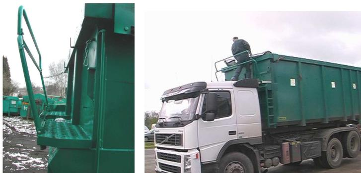
L'inclinaison du garde-corps est réglée par une chaînette placée à l'opposé de l'échelle et par les butées à la base des montants.
