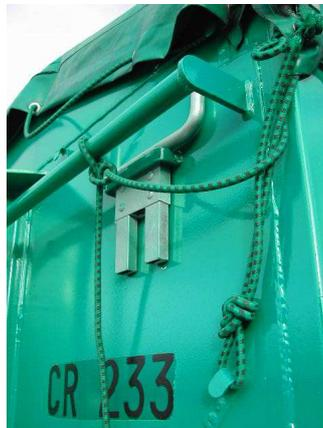
Pour éviter les coincements de bâche et éviter que la règle passe sous les supports, les guides intérieurs situés aux extrémités du caisson ont été élargis à 20 cm et rapprochés des cloisons du caisson en ne laissant plus qu'un espace de 3 cm.
