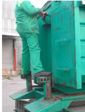
Une fois la bâche dépliée, le chauffeur descend du caisson et utilise une barre à crochet pour fixer le sandow sur les points d'ancrage placés tout autour du caisson.
