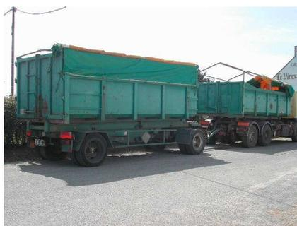
Le bâchage est réalisé soit par traction manuelle sur la toile d'avant en arrière (déplacement du chauffeur sur les bords du caisson), soit par déroulement latéral grâce à une règle incorporée dans la bâche (déplacement du chauffeur sur la largeur avant du caisson).
