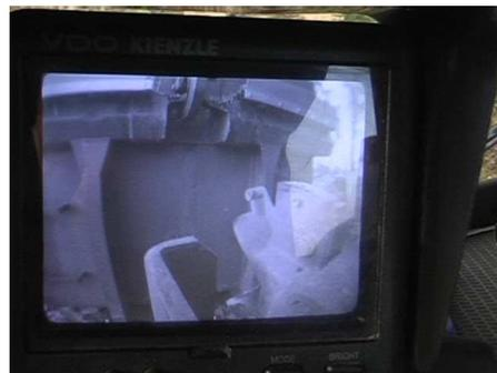
Cette caméra est également d'une assistance précieuse pour l'attelage de la flèche de la remorque ou le transfert de caisson sur une remorque. Elle permet un meilleur contrôle de la trajectoire du camion lors des manœuvres de recul.
