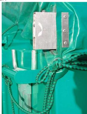
La clé (poignée d'enroulement) a été coupée pour laisser libre l'accès à la passerelle. Pour éviter d'être perdue, elle est bloquée sur un support contre la paroi du caisson. Deux pointes ajoutées permettent à la clé de s'encastrer dans les logements creux de la règle.
