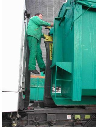
Il tourne la poignée de la règle pour dérouler la bâche sur les 3 points d'appuis transversaux (2 extrémités et un arceau métallique central). Il contourne une 2<sup>ème</sup> fois le bras hydraulique pour terminer le bâchage.
