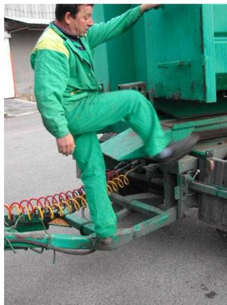
Le déplacement d'un côté à l'autre oblige à marcher sur les butées de blocage du caisson. Cette posture est extrêmement instable.
